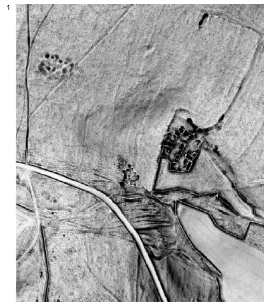
Le LiDAR ( Light Detection and Ranging ) ou lasergrammétrie aéroportée est une méthode de relevé détaillé des reliefs du sol. Depuis un avion, un scanner-laser balaye le sol, même à travers les feuilles des arbres, et enregistre les échos réfléchis par les obstacles. Des traitements informatiques ne sélectionnant que le dernier écho, au niveau du sol, produisent un MNT (Modèle Numérique de Terrain) à partir duquel des algorithmes permettent d'obtenir une image reflétant précisément les microreliefs ; ici procédé "sky view factor". C'est une méthode très performante pour repérer les aménagements humains sous couvert forestier.
