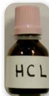
Détection du "calcaire actif" avec l'acide chlorhydrique
